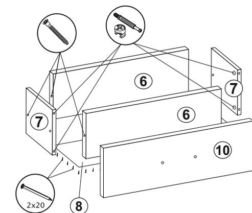
Ручку на створки (10) приворачивать винтами M4x10. Ответные части направляющих устанавливать по центру деталей ящиков (7) шурупами 4x16.
