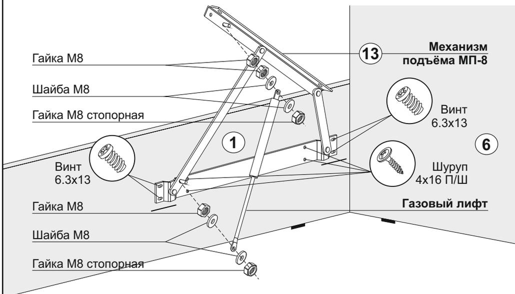
**Рис.3:** Монтаж механизма подъёма МП-8 (13) к ортопеду (12)
